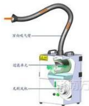
图 4-4 移动式焊接烟尘净化器工作原理图
